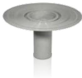
Scarico centrale a deflusso verticale in polipropilene di altezza 180 mm con uscita diametro 70 mm, senza sifone, da utilizzare come accessorio in combinazione con Aquaform Out Kit nei sistemi AquaExpert.
