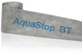
Nastro adesivo in butile rivestito di polipropilene non tessuto alcali-resistente ad elevata adesione provvisto posteriormente di pellicola siliconata pretagliata a metà altezza per giunti perimetrali in presenza di guaina bituminosa, PVC, legno, policarbonato, vetro, materiale plastico o metallo nei sistemi AquaExpert.
